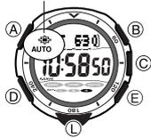
La retroilluminazione impiega un pannello elettroluminescente (EL) che fa illuminare l'intero display per facilitare la visione delle indicazioni al buio. La funzione di illuminazione automatica dell'orologio fa accendere automaticamente la retroilluminazione quando si orienta l'orologio verso il proprio viso.
