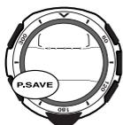
Se l'indicatore P.SAVE è visualizzato sul display (lampeggiante o stabilmente illuminato), significa che la visualizzazione sul display è assente perché la funzione di risparmio energetico dell'orologio ha spento il display per conservare energia. La funzione di risparmio energetico fa spegnere automaticamente il display e fa entrare l'orologio in uno stato di riposo ogni volta che l'orologio viene lasciato in un luogo buio per un certo lasso di tempo.
