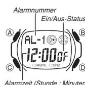
Im Alarm-Modus stehen fünf voneinander unabhängige Alarmer zur Verfügung. Wenn ein Alarm eingeschaltet ist, ertönt mit Erreichen der dafür eingestellten Alarmzeit ein Alarmton. Einer der Alarmer ist ein Schummeralarm, die anderen vier sind einmalige Alarmer. Sie können darüber hinaus ein stündliches Zeitsignal einschalten, das jede volle Stunde mit zwei Pieptönen meldet.
