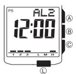
1. En el modo de alarma, utilice **C** para pasar a través de las pantallas de alarma, hasta visualizar la alarma cuya hora desea ajustar.
