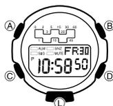
Questo orologio dispone di un pannello elettroluminescente (EL) che fa illuminare l'intero display per facilitare la visione delle indicazioni al buio.
