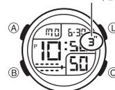
Il display dell'orologio è illuminato da un LED (diode a emissione luminosa) e da un pannello a fibra ottica per una facile visione delle indicazioni al buio.
