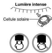
L'électricité générée par la cellule solaire de la montre s'accumule dans une pile interne. Si vous laissez ou utilisez la montre à un endroit où elle n'est pas exposée à la lumière, sa pile s'usera. Veuillez exposer le plus souvent possible la montre à la lumière.
