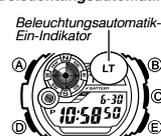
Halten Sie im Uhrzeitmodus etwa drei Sekunden lang (B) gedrückt, um die Beleuchtungsautomatik ein- (LT angezeigt) bzw. auszuschalten (LT nicht angezeigt).
