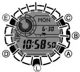
L'afficheur de la montre est éclairé pour être mieux visible à l'obscurité. Le commutateur d'éclairage automatique de la montre s'active lorsque vous tournez la montre vers votre visage, et à ce moment l'afficheur s'éclairc.
