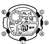
1. En mode Alarme, utilisez (A) pour faire défiler les écrans d'alarme jusqu'à ce que l'alarme dont vous voulez régler l'heure apparaisse.
