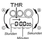
Der Countdowntimer kann auf eine Zeit im Bereich von einer Minute bis 24 Stunden eingestellt werden. Wenn der Countdown Null erreicht, ertönt ein Alarm. Der Countdowntimer besitzt auch eine Wiederholautomatik und einen Ablaufpieper, der den Ablauf des Countdowns signalisiert.
