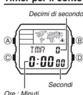
È possibile impostare il timer per il conto alla rovescia nella gamma compresa fra 1 secondo e 24 ore. Quando il conto alla rovescia giunge a zero, una suoneria suona.
