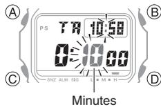
5. Utilisez les boutons (B) et (D) pour modifier le réglage des minutes de la minuterie.
