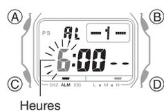
4. Utilisez les boutons (B) et (D) pour modifier le réglage des heures.
