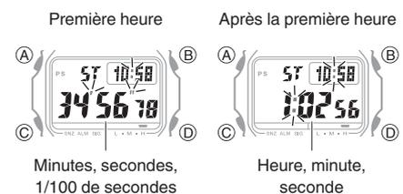
3. Appuyez sur le bouton (A) pour remettre à zéro la mesure.
