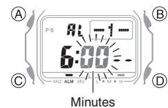
6. Utilisez les boutons (B) et (D) pour modifier le réglage des minutes.
