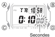
7. Utilisez les boutons (B) et (D) pour modifier le réglage des secondes.
