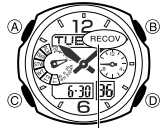
Indicateur de mode de rétablissement de la charge
