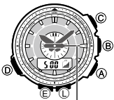
Von Sekundenzeiger angezeigte Höhendifferenz
