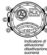
1. Nel modo di suoneria, usare **(E)** per scorrere le schermate di suoneria sulla parte superiore del display finché viene visualizzata quella per cui si desidera cambiare l'ora.
