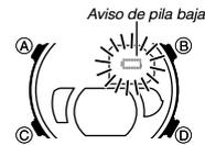
La carga de las pilas está baja. Las operaciones del reloj se deshabilitan mientras el aviso de pila baja está destellando en la pantalla superior. Si el aviso de pila baja desaparece después de que la carga de las pilas se haya recuperado, pero comienza a destellar brevemente después, significa que deberá hacer cambiar las pilas del reloj.
