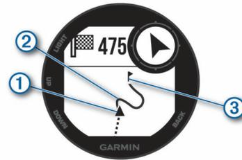
Auf der Karte werden die aktuelle Position ①, der zu verfolgende Track ② sowie das Ziel ③ angezeigt.
