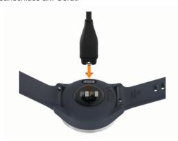
3 Schließen Sie das USB-Kabel an eine Stromquelle an, um das Gerät einzuschalten (Aufladen des Geräts, Seite 11).
